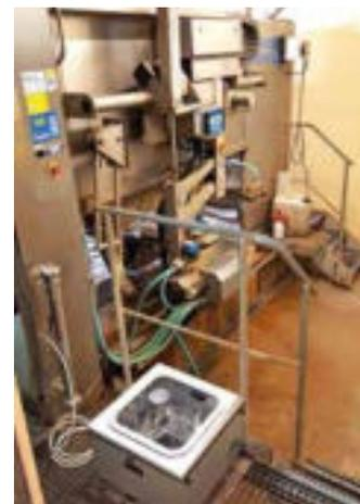
Das LKV-Shuttle ist für 90 Proben ausgelegt.
